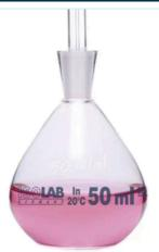
Fabricado en vidrio según la norma ISO 3507. Tanto el cuerpo como el tapón llevan el mismo número de código de identificación. Calibrado junto con el tapón con una precisión de 0,001 ml. El volumen neto está grabado en el cuerpo con esmalte azul. Con tapón con extremos pulidos.
