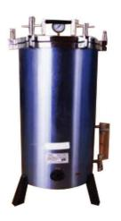
Autoclave vertical de acero inoxidable eléctrica de 3 calores, con canastilla de acero inoxidable y tapa de bronce. Con resistencia de cobre aisladas, control manual o mecanismo automático con señales luminosas.
